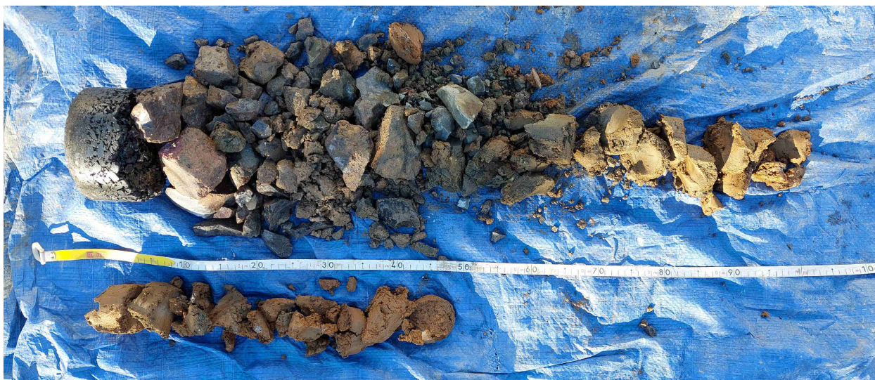
Sonda S2 – odebraný jádrový vývrt HAV a vrtné jádro
