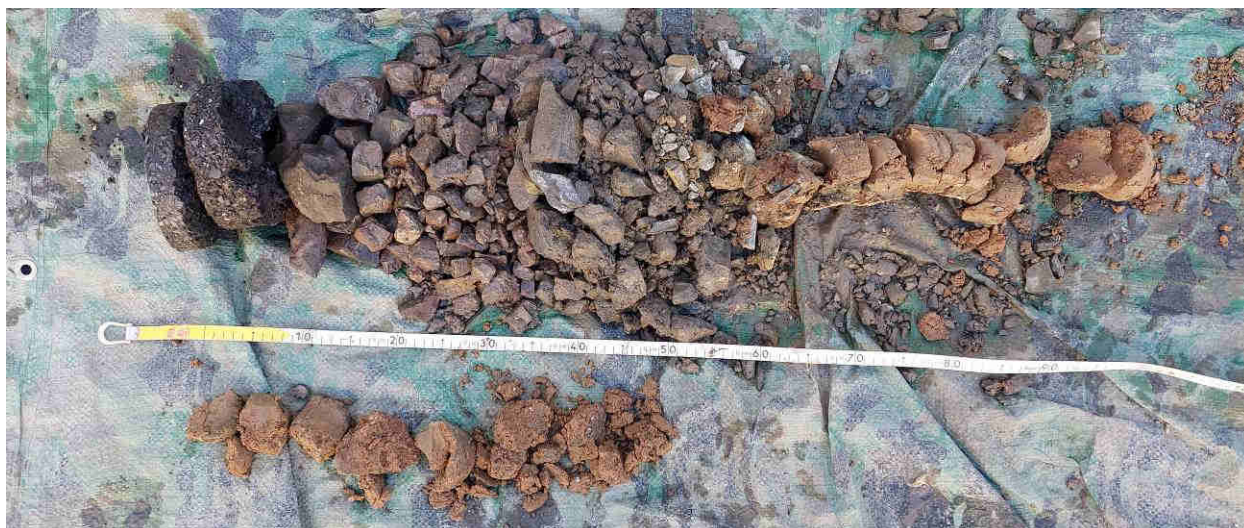
Sonda S1 – odebraný jádrový vývrt HAV a vrtné jádro
