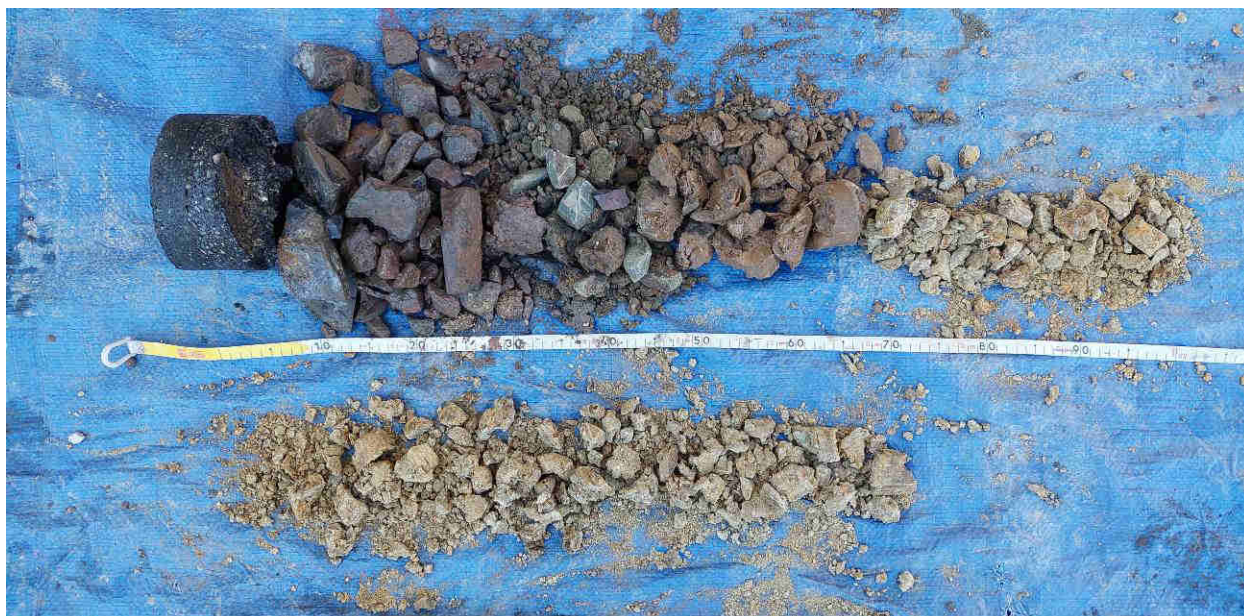
Sonda S3 – odebraný jádrový vývrt HAV a vrtné jádro
