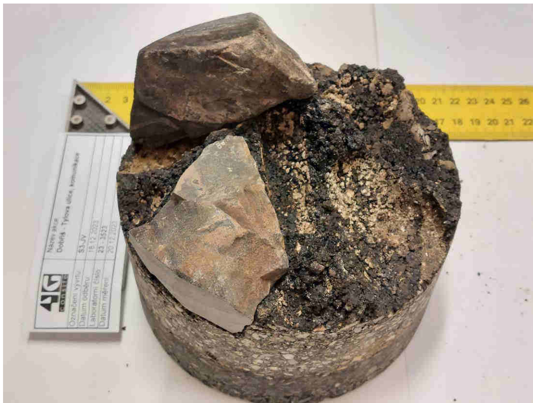
Sonda S3 – odebraný jádrový vývrt HAV s ukázkou zatlačení hrubých zrn drceného kameniva ze vsypného makadamu
